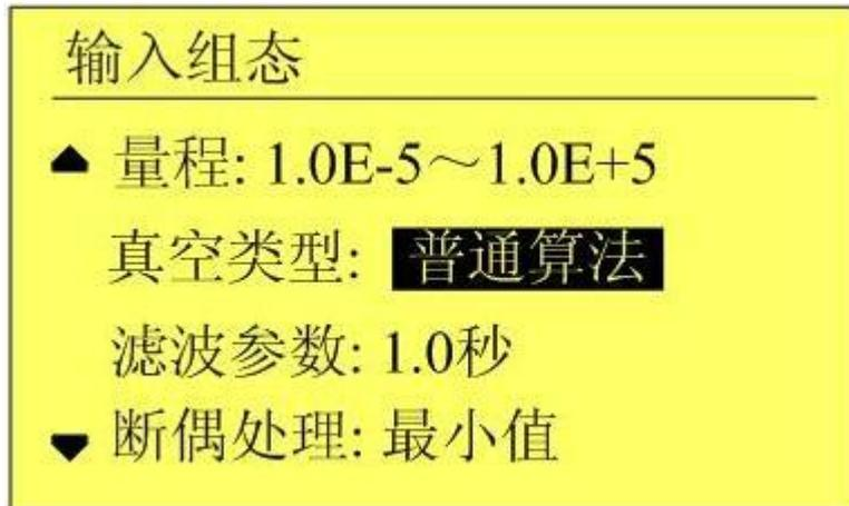
量程：设置当前信道的输入信号量程上下限。当真空类型选择普通算法或分段算法时量程上下限以科学计数法表示。
